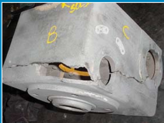
Caixa de redução quebrada devido a esforço excessivo
