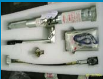
Bomba e mangueiras para aplicação do selante
